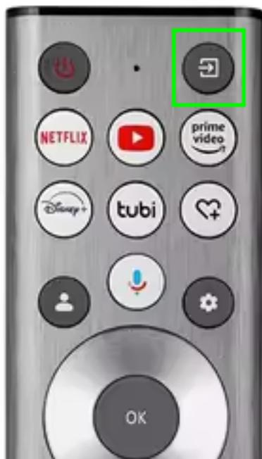
Drücke auf der Fernbedienung den «**Input**» Knopf, der sich rechts oben befindet (grüner Kasten). Damit erscheint der «Home» Bildschirm und dort wechsele mit der «**Unten**» Taste der Fernbedienung auf die unteren Kachel.
