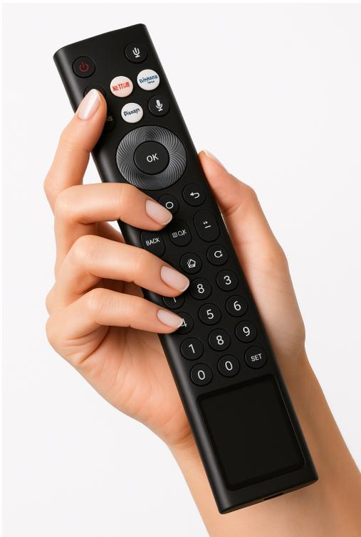
Mit der **Original-Fernbedienung des Laser Cinema** wird mit dem «Ein» Knopf (**die rote Taste links oben**) zusätzlich zum Laser Cinema auch die elektrische Schublade, die Schiebetüre und/oder Leinwand sowie das Soundsystem ein- und ausgeschaltet.
