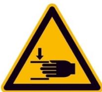
Bei automatisch bewegten Schubladen, Türen und Leinwänden besteht die Gefahr, dass **Finger oder andere Körperteile eingeklemmt** werden können.
